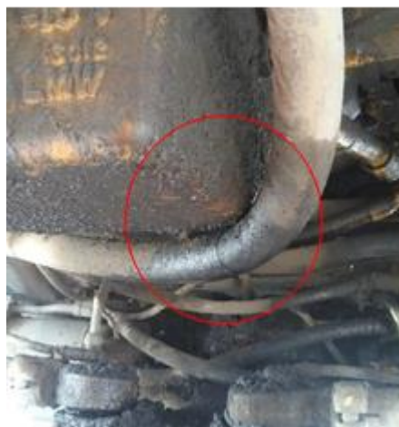
Gambar 3. Hose bersentuhan dengan komponen lain
