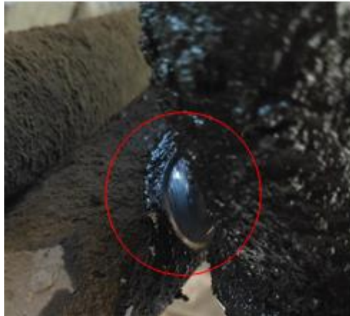
Gambar 5. Kerusakan Hose Akibat Abrasi
