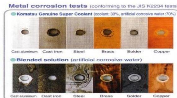
Gambar 5 Metal Corrosion Tes Sumber : AFNAC Technical Guide
