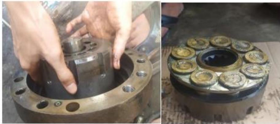
Gambar 4. Proses pembongkaran barrel dan piston
