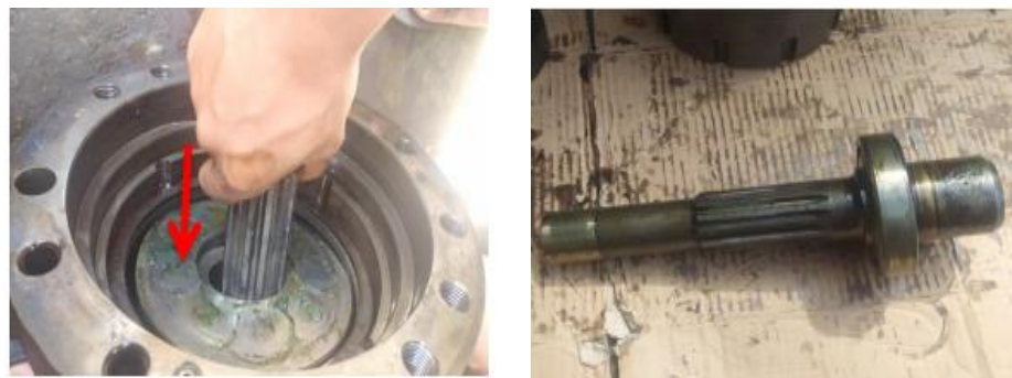
Gambar 5. Proses pembongkaran camplate dan shaft
