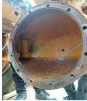
Gambar 6. Terjadi kontaminan pada differential case
