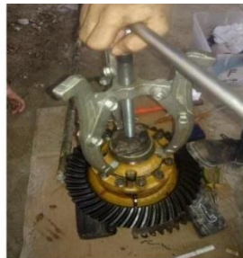
Gambar 4. Melepas bearing cone menggunakan special tools puller
