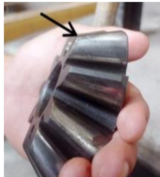
Gambar 7. Terjadi scratch pada pinion gear
