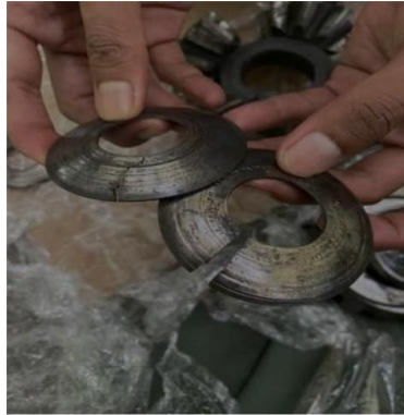
Gambar 9. Kondisi thrust washer mengalami fatigue
