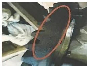
Gambar 8. Kondisi bevel gear terjadi water mark
