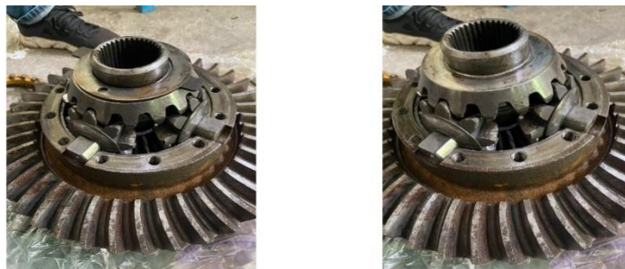
Gambar 5. Melepas thrust washer dan side gear
