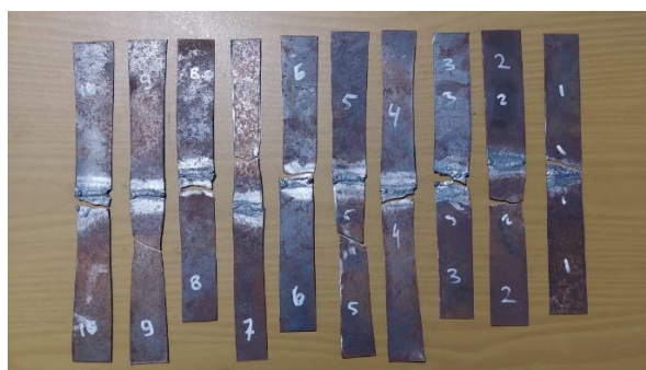
Gambar 3. Speciment 1 – 10 Setelah Dilakukan Pengujian Tarik
