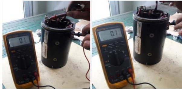
Gambar 10. Hasil Pengujian Kebocoran Coil/ Winding pada Fiel Winding
