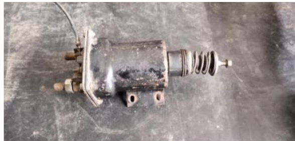
Gambar 6. Pemeriksaan Visual pada Solenoid
